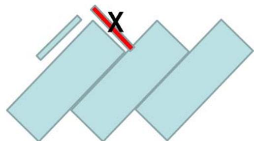
Producetak daske ne smije biti pod kutem prikazanim na slici
